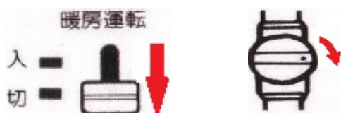
①リモコンスイッチ ②給湯器下部の元栓
