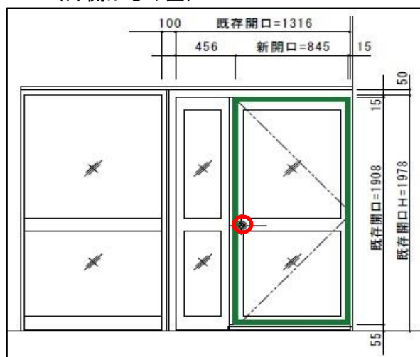
図4 非常用ドアの新ゴムシール配置図 (外側からの図)
