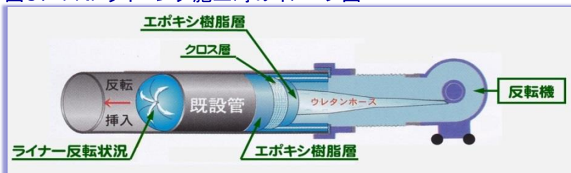
図3: FRPライニング施工時のイメージ図
